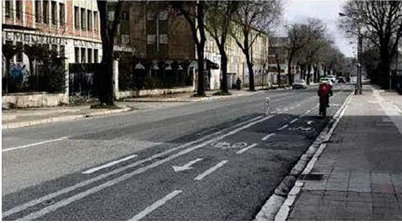
Al producirse circulación ciclista en dos sentidos, las bandas bidireccionales por la derecha requieren una mayor protección que las bandas unidireccionales, tal y como se explica en el capítulo 3. Se recomienda aumentar el resguardo (0,70 m) y disponer protecciones puntuales mediante elementos de balizamiento o protección continua (bordillo), solución esta última que aporta mayor seguridad. El espacio recomendable mínimo para implantar esta opción de diseño es de 3,45 m.
