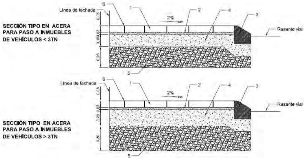
1. ADOQUÍN PREF. HORMIGÓN COLOR DE 8 CM DE ESPESOR MOD. HOLANDA SEGÚN NORMA UNE-EN 1338
